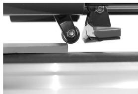
Schieben Sie das Rad nach vorne, indem Sie den Griff mit mittlerem Druck nach unten drücken.
