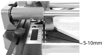
Wskazówki: Nie wkładaj płytki zbyt głęboko, aby mieć pewność, że linia nacięcia będzie jedną linią. Po nacięciu lepiej odciągnąć uchwyt, aby umożliwić delikatne cofnięcie się płytki.
