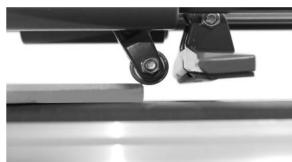
Setzen Sie das Schneidrad an der hinteren Kante der Fliese an.
