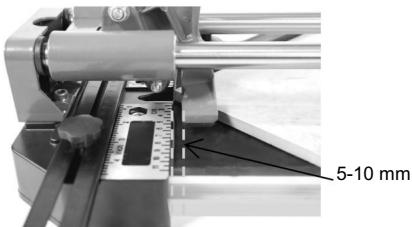
Conseils : Ne placez pas la tuile trop à l'intérieur pour vous assurer que la ligne de marquage est une ligne entière, après le marquage, il est préférable de tirer la poignée vers l'arrière pour laisser le brise-carreaux reculer légèrement 5-10 mm, c'est la meilleure position pour casser le carreau.
