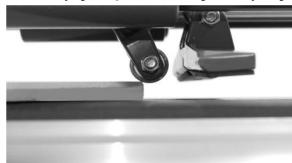
Umieść kółko tnące na tylnej krawędzi płytki.
