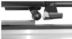
Coloque la rueda de corte en el borde trasero de la baldosa.
