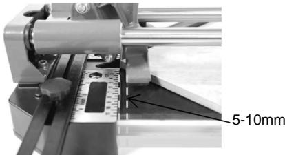
Tips: Plaats de tegel niet te ver naar binnen om ervoor te zorgen dat de snijlijn een hele lijn is. Na het snijden is het beter om de hendel terug te trekken zodat de breker iets terug kan slaan.
