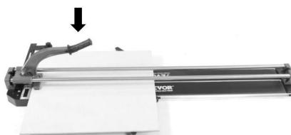
Po nacięciu i bez przesuwania położenia kafelka, łamacz jest lekko na przodzie krawędź płytki i ogranicznik przedni.
