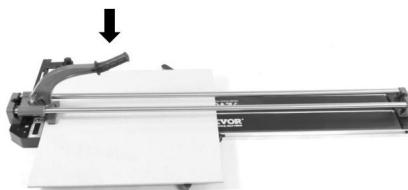
Après avoir marqué et sans déplacer la position de la tuile, le disjoncteur est légèrement en avant bord de la tuile et butée avant.
