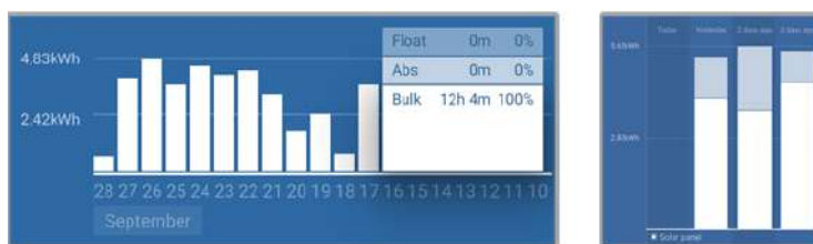
Po lewej: Przykład systemu, który cały czas spędza w fazie masowej. Po prawej: Podział faz ładowania - System spędza czas w fazie masowej i w fazie wchłaniania.
