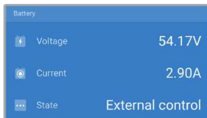
Aplikacja VictronConnect informuje, że ładowarka jest sterowana zewnątrz.
