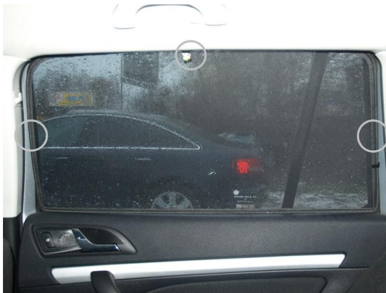
Rys.1 - Miejsca założenia uchwytów na drzwiach
