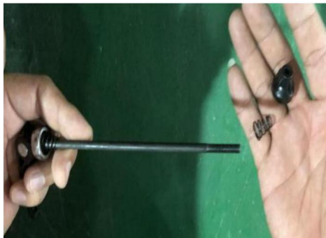
8. Wyjmij oś szybkozamykającą, aby zamontować przednie koło
