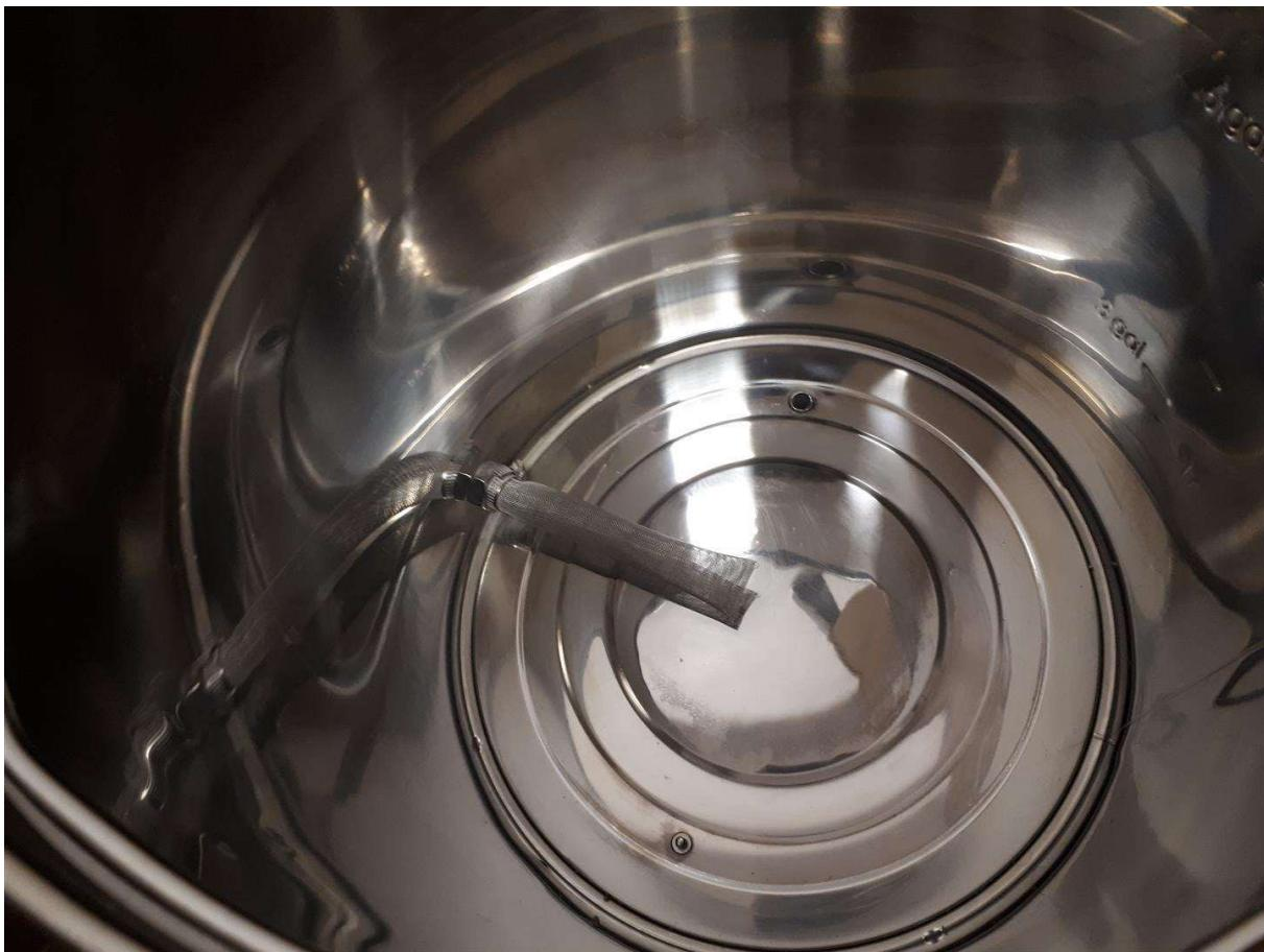
Dévissez l'extrémité inférieure du tube et passez-le à travers le tamis inférieur puis vissez-le de l'autre côté :
