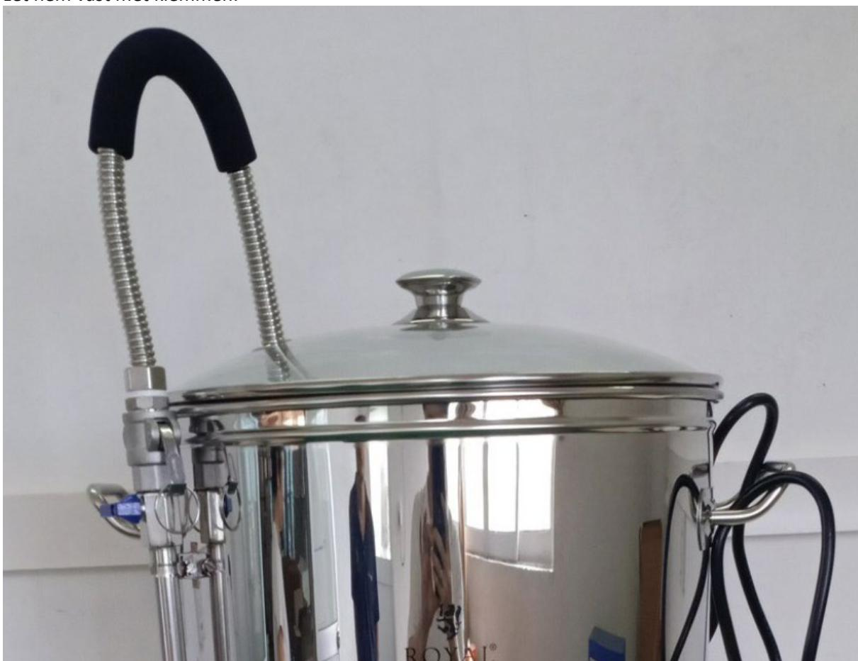
Fest det avlange filteret med en slangeklemme inne i kjelen ved utløpet:
