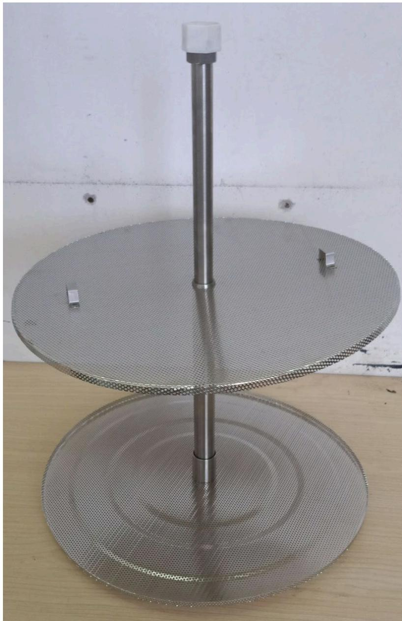
Nasaděte přepadovou trubici do otvoru ve víku, poté ji vložte do trubky na kotli a zajistěte svorkami:
