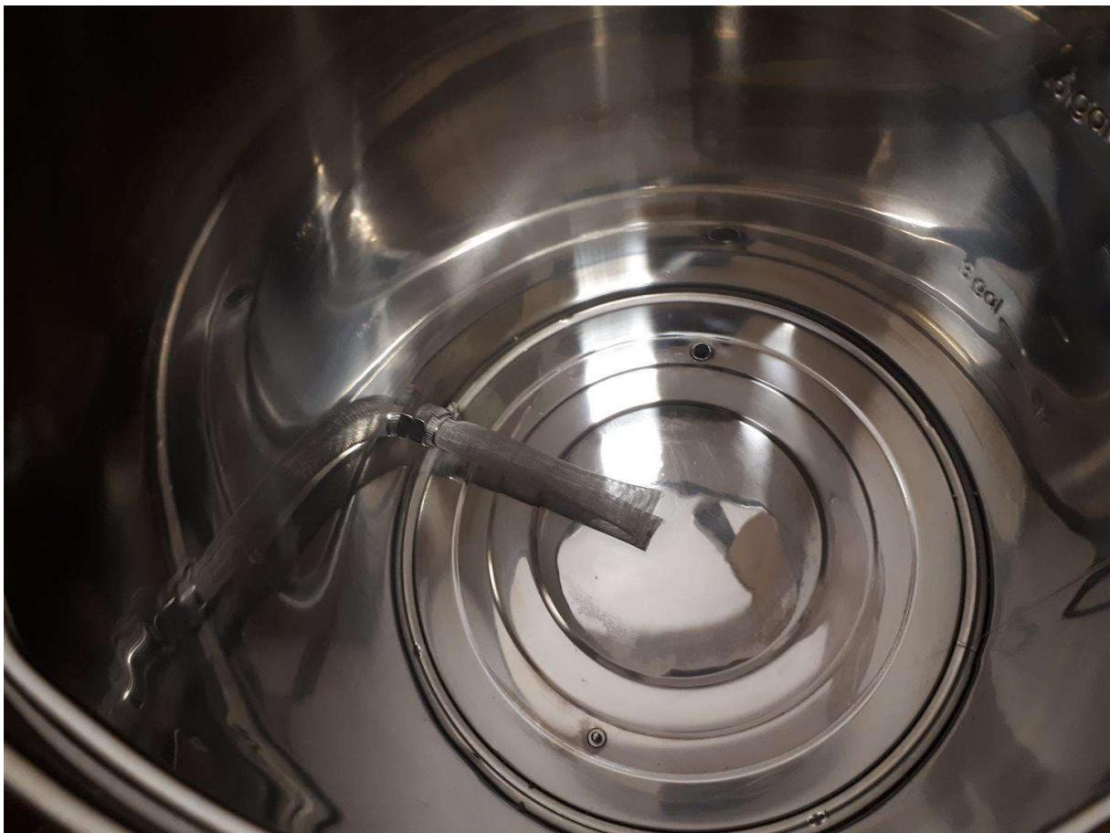
Desaparafuse a extremidade inferior do tubo e passe-o pela peneira inferior e depois enrosque-o pelo outro lado:
