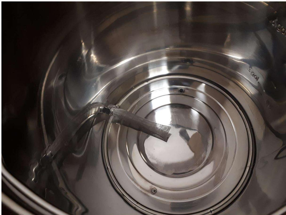
Desenrosque el extremo inferior del tubo y páselo por el tamiz inferior y luego enrósquelo por el otro lado:
