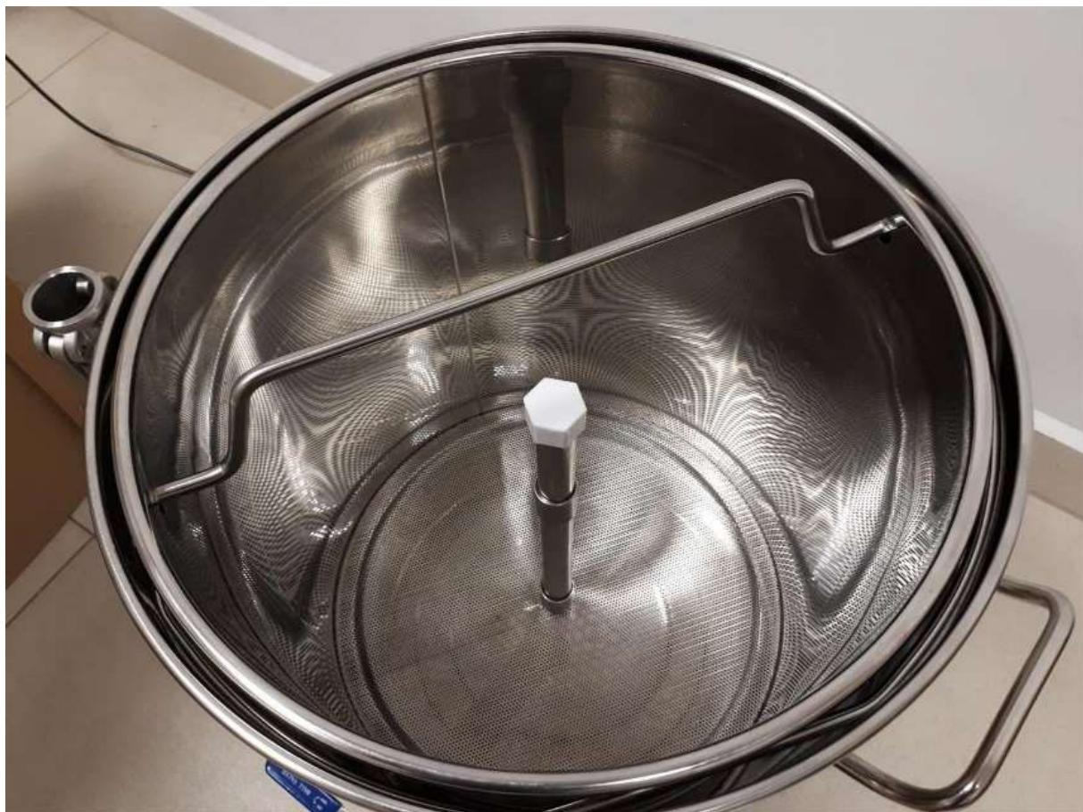
Na het vullen met mout verwijdert u de plastic dop, plaatst u de bovenste zeef en schroeft u het bovenste uiteinde van de buis weer vast:
