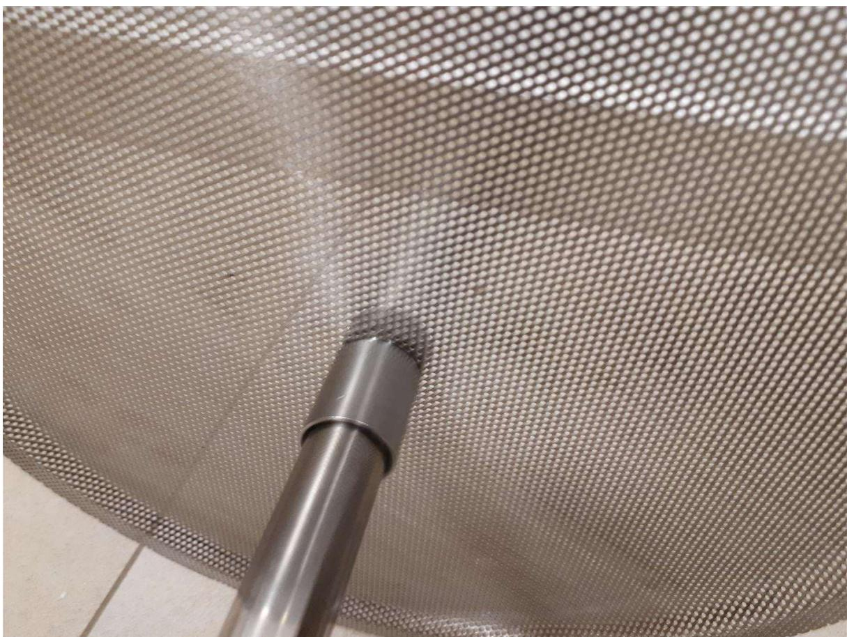
Sigtet, der er samlet på denne måde, skal placeres inde i cylinderen, der placeres i kedlen, men inden dette skal den øverste ende på røret skrues af og proppes med en hvid plasthætte - kedlen vil være klar til at blive fyldt med malt:
