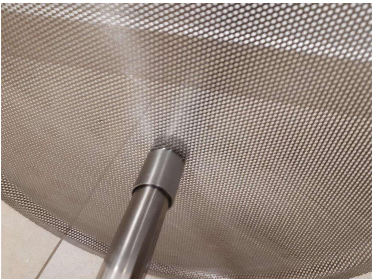
Takto zostavené sito je vhodné umiestniť do valca, ktorý bude umiestnený v kotli, ale ešte predtým odskrutkujte horný koniec trubice a upchajte ho bielym plastovým uzáverom - kotol bude pripravený na plnené sladom:
