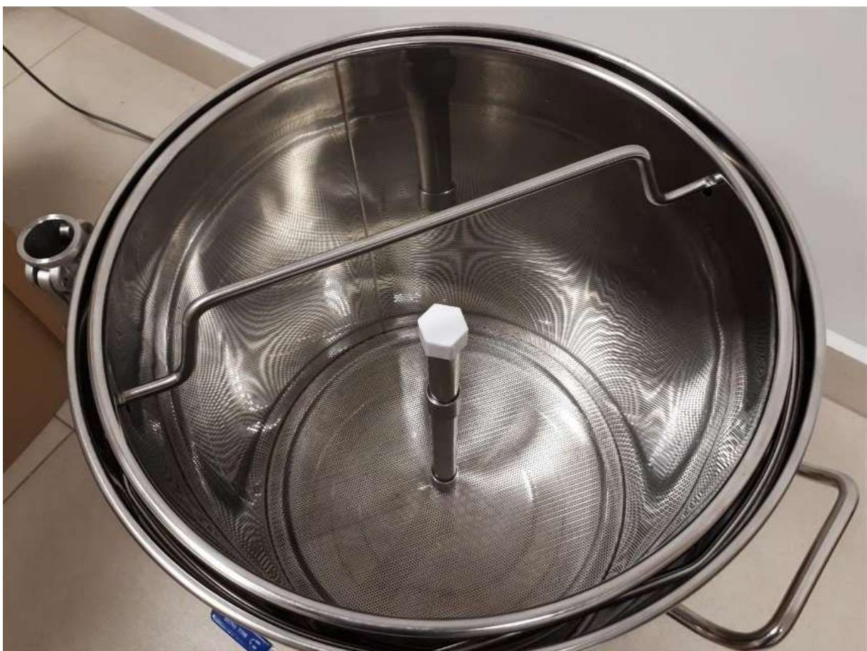
Efter påfyldning af malt fjernes plasthætten, den øverste sigte sættes på, og den øverste ende af røret skrues på igen:
