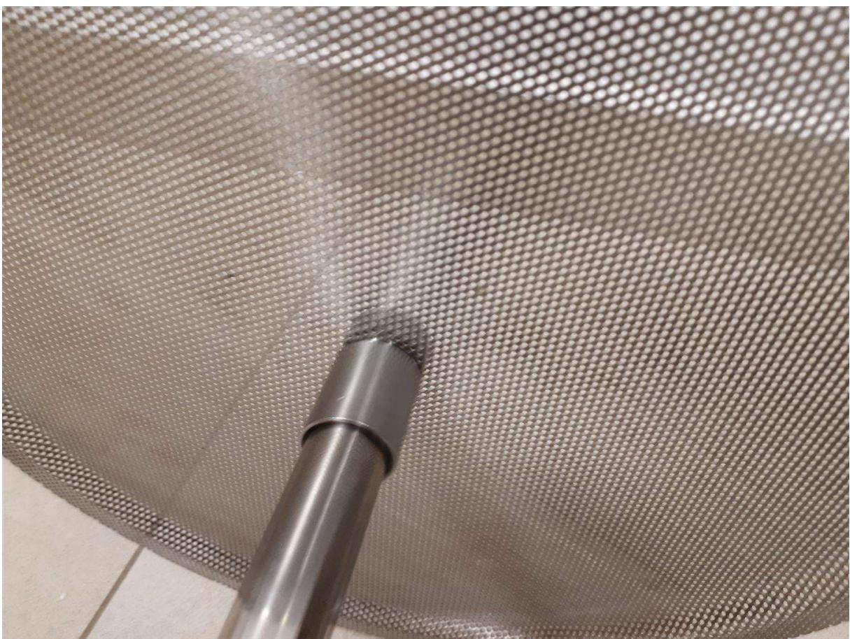
Il vaglio, così assemblato, dovrà essere posizionato all'interno del cilindro che verrà posto nella caldaia, ma prima di ciò, l'estremità superiore del tubo dovrà essere svitata e tappata con un tappo di plastica bianca: la caldaia sarà pronta per essere utilizzata. ripieno di malto:
