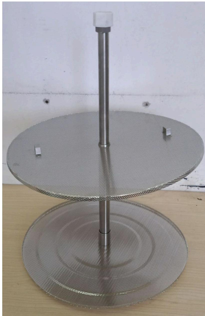
Montare il tubo di troppopieno nel foro del coperchio, quindi posizionare il tubo sulla caldaia e fissarlo con le fascette:
