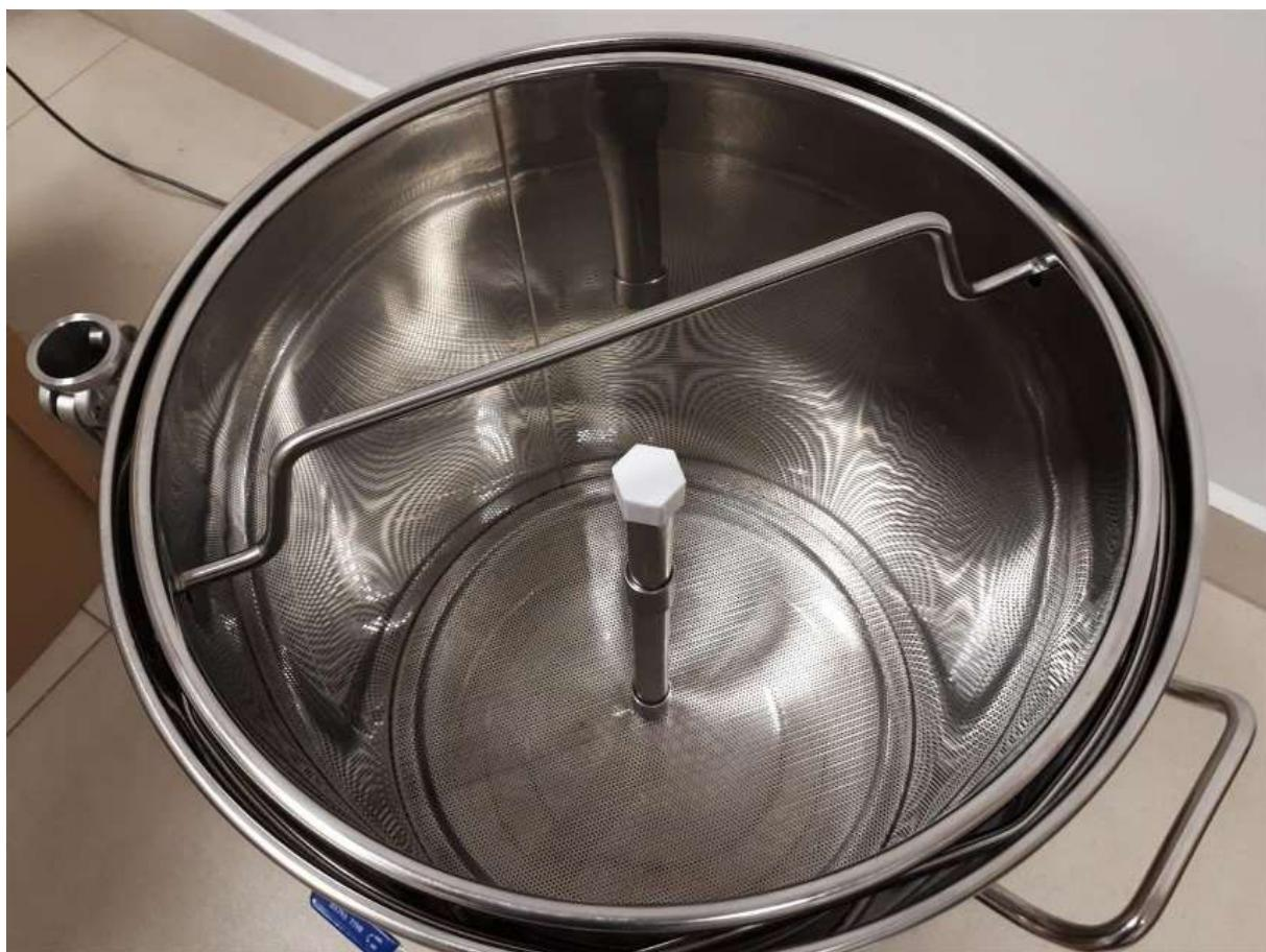
Po naplnění sladem sejměte plastový uzávěr, nasadte horní sítko a opět našroubujte horní konec tuby:
