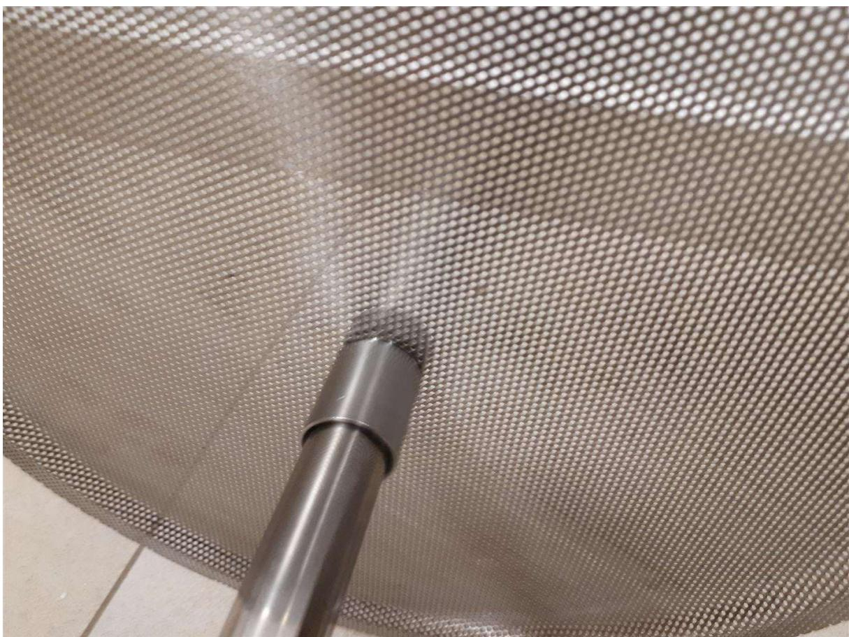
A peneira assim montada deve ser colocada dentro do cilindro que será colocado na caldeira, mas antes disso, a extremidade superior do tubo deve ser desparafusada e tampada com uma tampa plástica branca - a caldeira estará pronta para ser cheio de malte:
