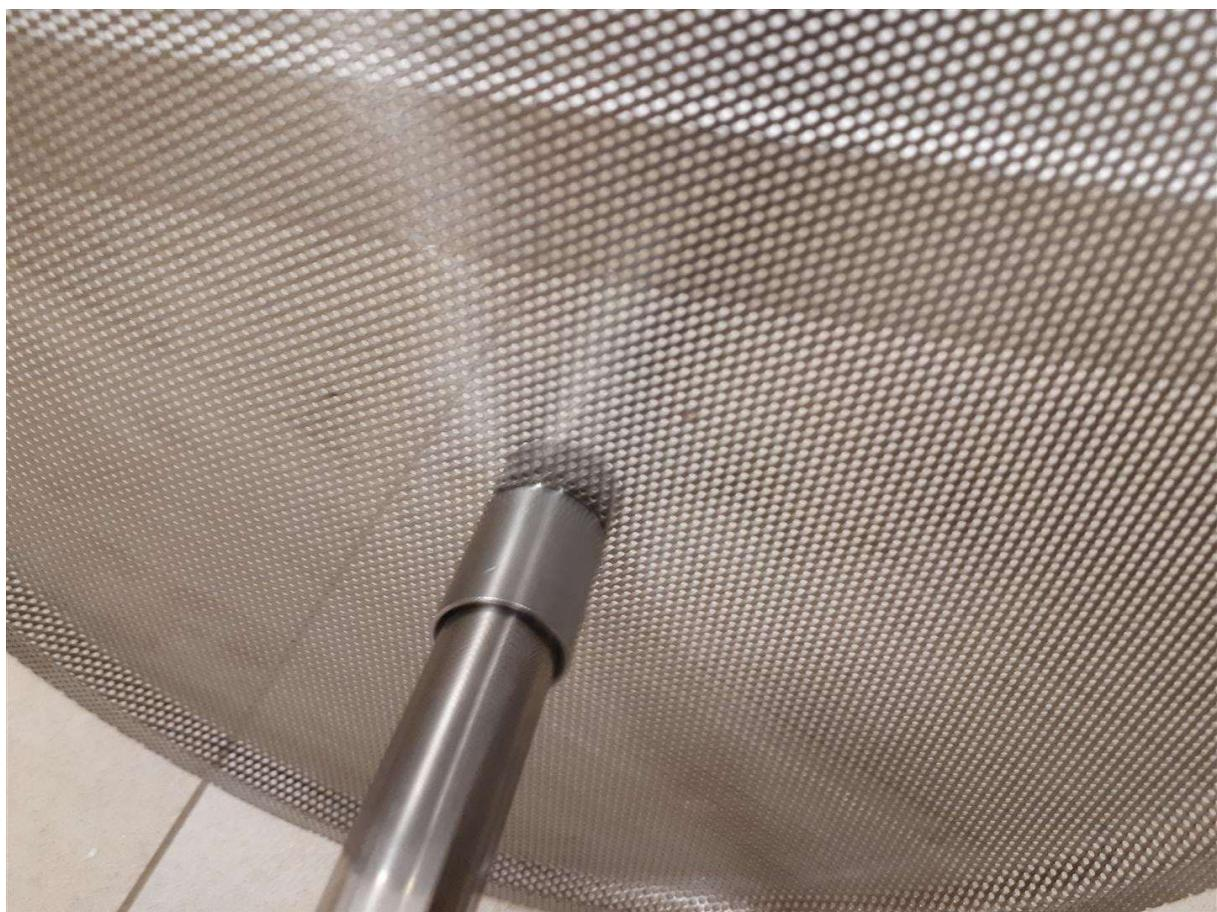
Silen, monterad på detta sätt, ska placeras inuti cylindern som ska placeras i pannan, men innan detta ska den övre änden på röret skruvas av och pluggas igen med en vit plastkåpa - pannan kommer att vara redo att användas fylld med malt:
