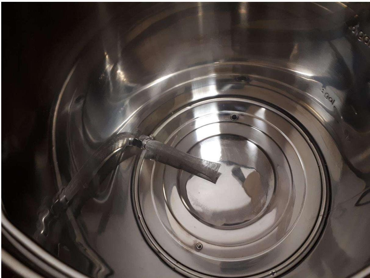
Kierrä putken alapää irti ja laita se alemman seulan läpi ja ruuvaa sitten kiinni toiselta puolelta:
