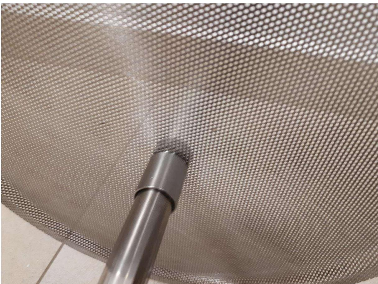
Zmontowane w ten sposób sito należy umieścić wewnątrz cylindra, który zostanie umieszczony w kotle, wcześniej jednak należy odkręcić górną końcówkę na rurce i zaślepić ją białą zakrętką z tworzywa – kocioł będzie gotowy do zasypu słodem:
