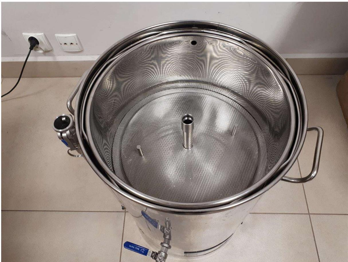
Vollständig montierte Siebe:
