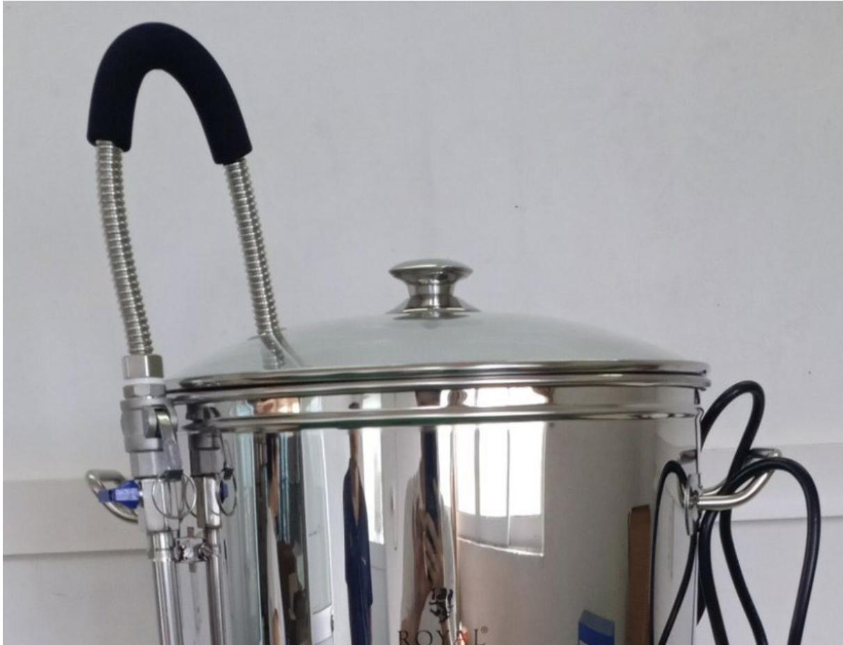
Zet het langwerpige filter vast met een slangklem in de ketel bij de uitlaat:
