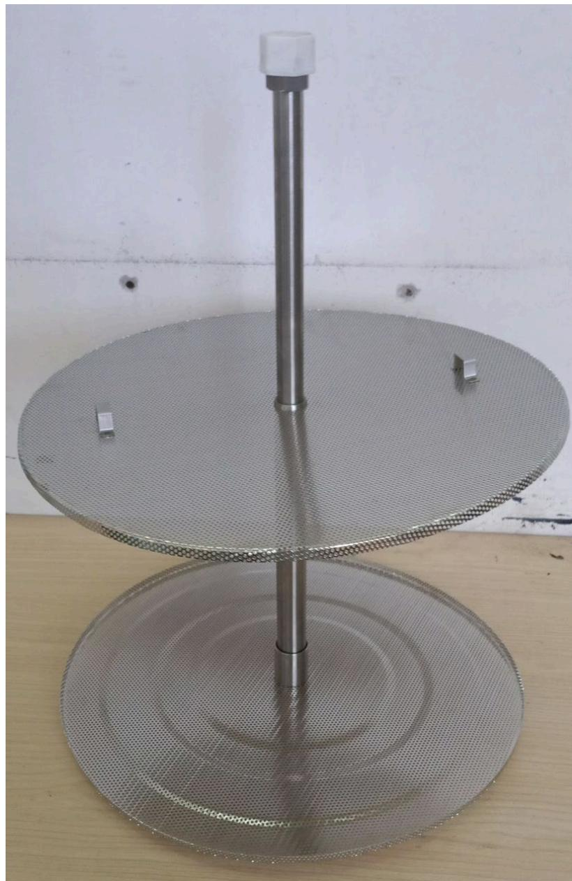
Rurkę przelewową dopasować do otworu w pokrywie, następnie umieścić w rurce na kotle i zabezpieczyć zaciskami:
