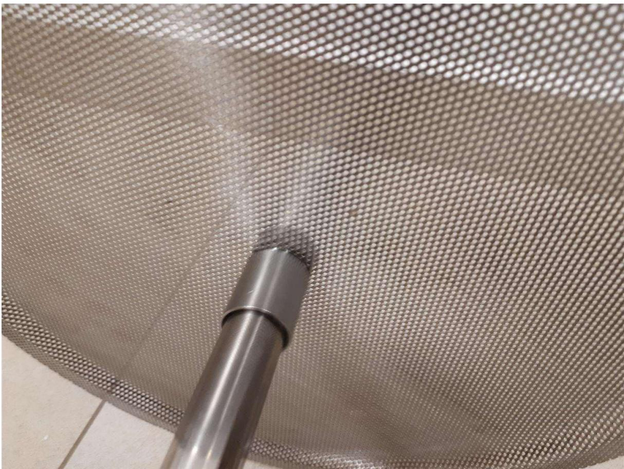
Takto sestavené síto by mělo být umístěno uvnitř válce, který bude umístěn v kotli, ale předtím je třeba odšroubovat horní konec na trubce a upat bílým plastovým uzávěrem - kotel bude připraven k použití plněné sladem:
