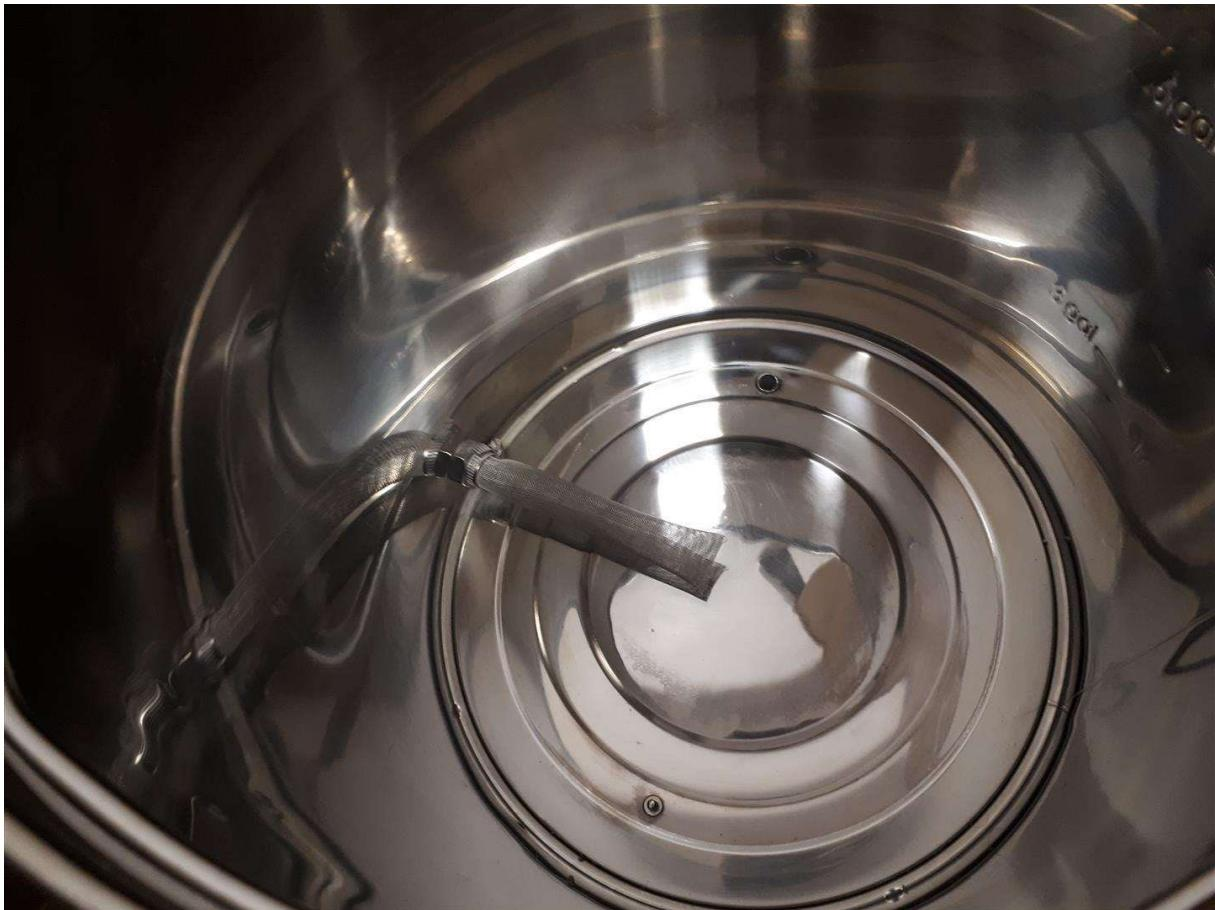
Skru den nederste ende af røret af, og før det gennem den nederste si, og skru det derefter på fra den anden side:
