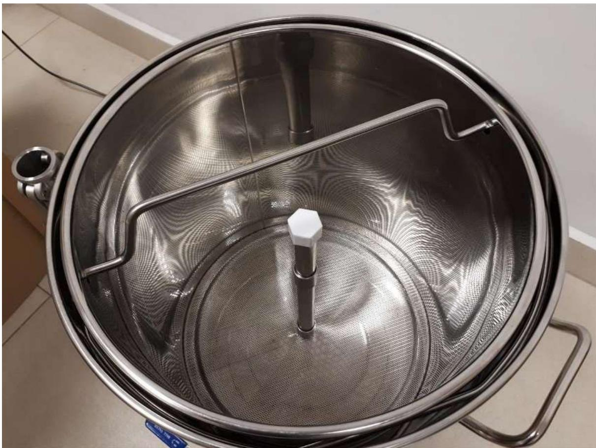
Após o enchimento com malte, retire a tampa plástica, coloque na peneira superior e rosqueie novamente a extremidade superior do tubo:
