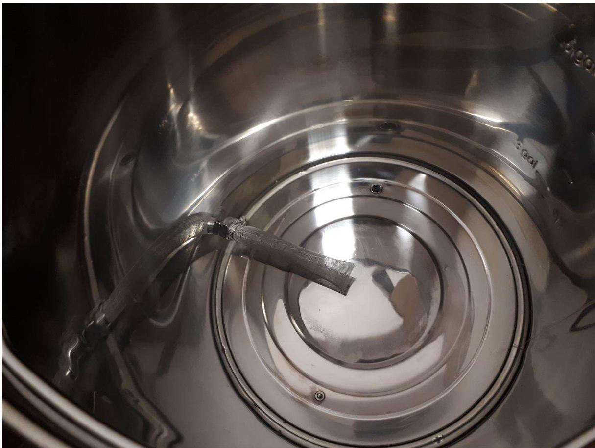
Schrauben Sie das untere Ende des Rohrs ab, stecken Sie es durch das untere Sieb und schrauben Sie es dann von der anderen Seite an:
