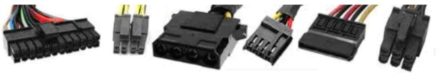
Кількість та тип штекерів живлення залежить від моделі блоку живлення. Під час вибору блоку живлення користувач повинен звернути увагу не тільки на його потужність, а також на кількість необхідних для підключення штекерів, розмір блоку живлення та спосіб його установки до корпусу комп'ютера. окремі моделі блоків живлення MODECOM мають модульну кабельну систему, що дозволяє підібрати необхідну кількість потрібних для підключення кабелів.
