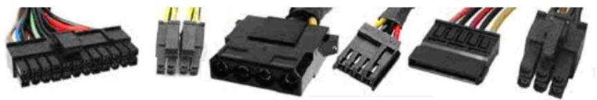
Numărul și tipul pinilor de alimentare depinde de modelul sursei. La se selectarea sursei, utilizatorul ar trebui să acorde atenție nu numai puterii acesteia, dar, de asemenea, numărului de pini necesari, dimensiunii sursei de alimentare și modului de instalare a acesteia în carcasă. Modelele selectate de surse de alimentare Modecom au o cablare modulară care vă permite să reglați cantitatea de cabluri necesară de conectare.
