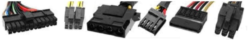
Le nombre et le type des connecteurs d'alimentation dépend du modèle du bloc d'alimentation. Lors de la sélection l'utilisateur doit prêter attention non seulement à la puissance d'un bloc d'alimentation, mais aussi à la quantité requise des connecteurs, la taille du bloc d'alimentation et le mode de sa mise en place dans le boîtier. Certains modèles d'alimentations MODECOM ont un câblage modulaire permettant la sélection de la bonne quantité de câblage nécessaire.
