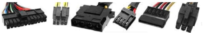
Ausgewählte Modelle von MODECOM PC-Netzteilen haben eine modulare Verkabelung, die Ihnen die richtige Anpassung der Menge der zum Stromanschluss benötigten Kabel ermöglicht.
