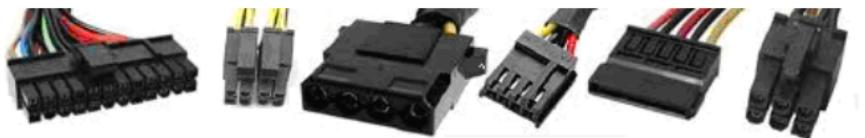
Število in vrsta priključkov je odvisna od modela napajalnika. Uporabnik more biti pri izbiri napajalnika pozoren ne samo na njegovo moč, ampak tudi na število potrebnih priključkov, velikost napajalnika in način njegove namestitve v ohišje računalnika. Izbrani modeli napajalnikov MODECOM imajo modularne kable, ki omogočajo priklop potrebnega števila žic.
