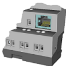
Rys. 31: Gniazdo RJ45, 8-biegunowe
