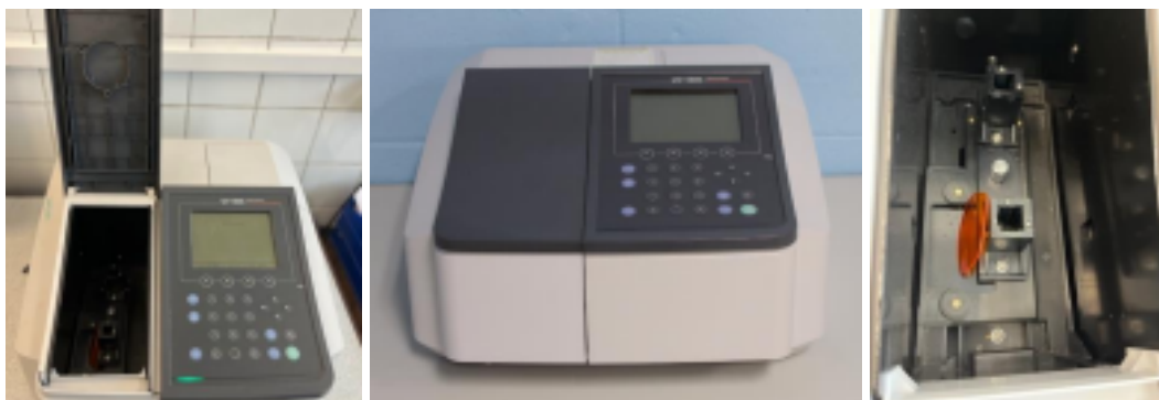
Zastosowany spektrofotometr UV-Vis wraz z próbką
