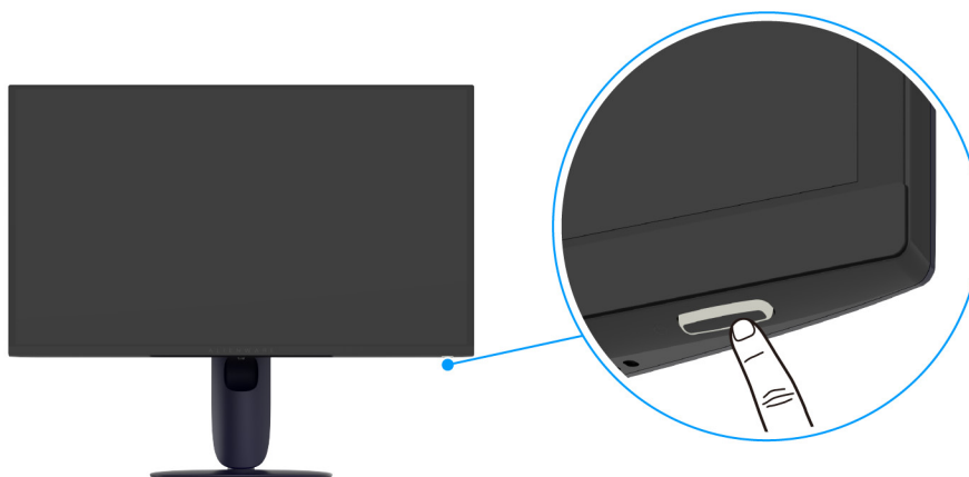
Rysunek 33. Włączanie monitora
