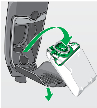
Zdjęcie 4.5 Otwieranie osłony filtra i wkładanie worka filtrującego
