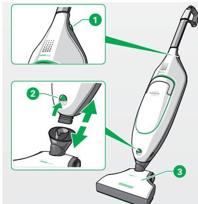
Zdjęcie 2.5 Demontaż przystawki (tu: automatyczna szczotka elektryczna)
