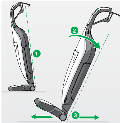
Zdjęcie 2.7 Transportowanie odkurzacza
