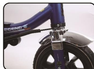
Przymocuj pręt sterujący do widełca
