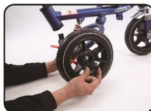
Założ plastikową osłonę osi koła
