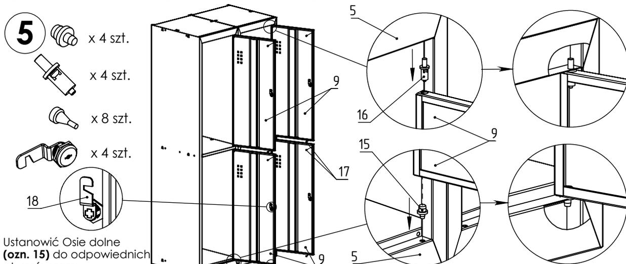
Zainstalować Zamek w drzwiach i (ozn. 18) i zamocować za pomocą nakrętki na zamku.
