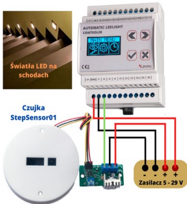
Schemat podłączenia czujki ruchu
