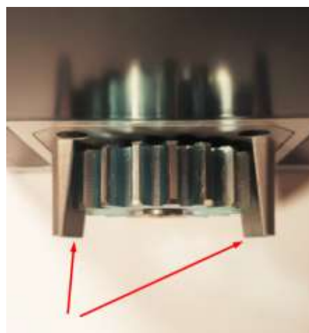
Rys. 4. Elementy osłonowe koła zębatego można skrócić
