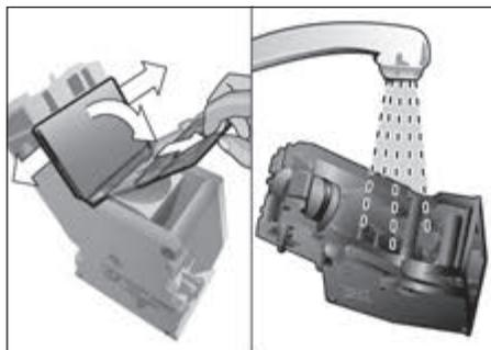
■ Dokładnie umyć pod strumieniem wody sito jednostki zaparzania.
