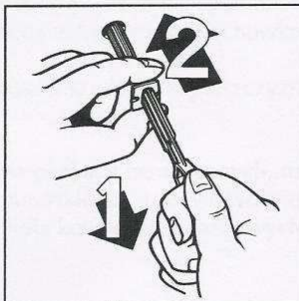
Pociągnąć mocno za uchwyt. Przesunąć nakładkę w kierunku ściany.
