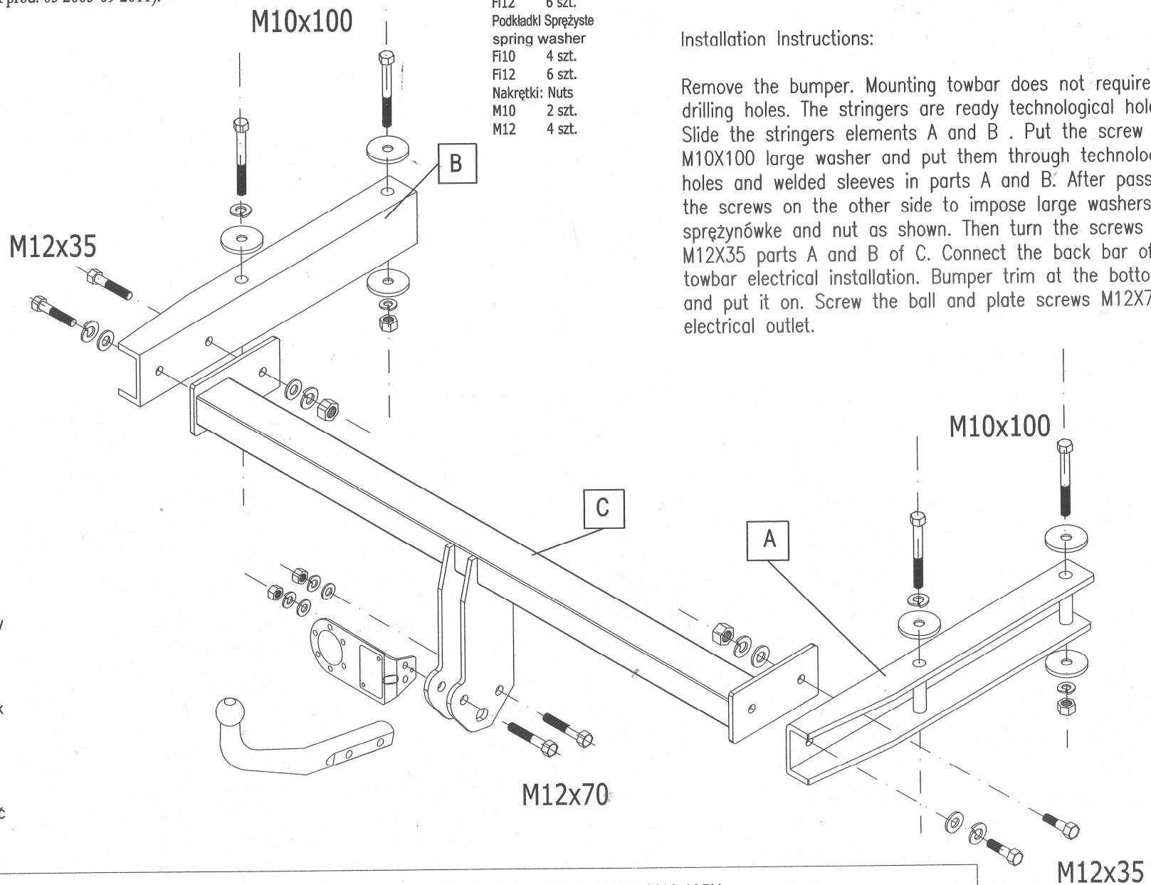
Moment skręcający dla śrub i nakrętek M8 25Nm; M10 55Nm; M12 85Nm; M14 135Nm ;M16 195Nm.
