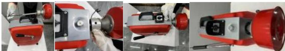
3. Coloque la máquina a 1 o 2 pies de la entrada de la tubería; una distancia excesiva puede provocar que el cable se enrolle.
