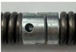
2. Utilizzare una molla da 3/8" per dragare la tubazione prima del lavoro di preparazione. ÿ Assicurarsi che l'interruttore sia in posizione OFF. ÿ Per prima cosa, rimuovere il tappo di plastica sul corpo
