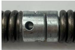
2. Verwenden Sie eine 3/8-Zoll-Feder, um die Rohrleitung vor den Vorbereitungsarbeiten auszubaggern.
