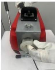
3. Wyciągnij sprężynę z pojemnika na sprężyny na około 10 cali, a następnie włóż sprężynę do maszyny od końca maszyny z otworem, podnieś sworzeń części pojemnika na sprężyny, wsuń pojemnik na sprężyny do kadłuba, upuść sworzeń, obróć, aż sworzeń wpadnie do otworu w maszynie (jak pokazano na rysunku).
