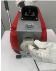
3. Ziehen Sie die Feder im Federbehälter etwa 10 Zoll heraus und stecken Sie die Feder dann vom Ende der Maschine mit einem festen Loch in die Maschine, heben Sie den Stift der Federbehälterteile an, drücken Sie den Federbehälter in den Rumpf, lassen Sie den Stift fallen und drehen Sie ihn, bis der Stift in das feste Loch der Maschine fällt (wie in der Abbildung gezeigt).
