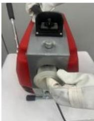
3. Estrarre la molla dal contenitore di circa 10 pollici, quindi inserirla nella macchina dall'estremità della macchina con un foro fisso, sollevare il perno delle parti del contenitore della molla, spingere il contenitore della molla nella fusoliera, far cadere il perno, ruotare il perno in modo che cada nel foro fisso della macchina (come mostrato nella figura).
