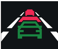
1. kontrola niebezpiecznej bliskości obiektu
