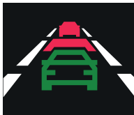
1. отслеживание опасного сближения с объектом
