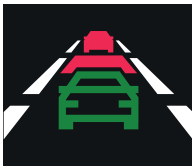
1. sledování nebezpečné blízkosti objektu
