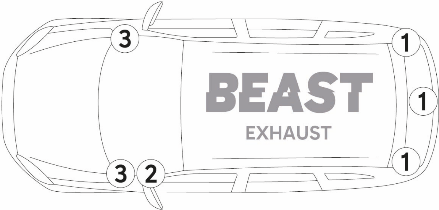
1 - Głośnik 2 - Pozycja klucza OBD 3 - Płożenie podstawy bezpiecznika i punktu uziemiającego
