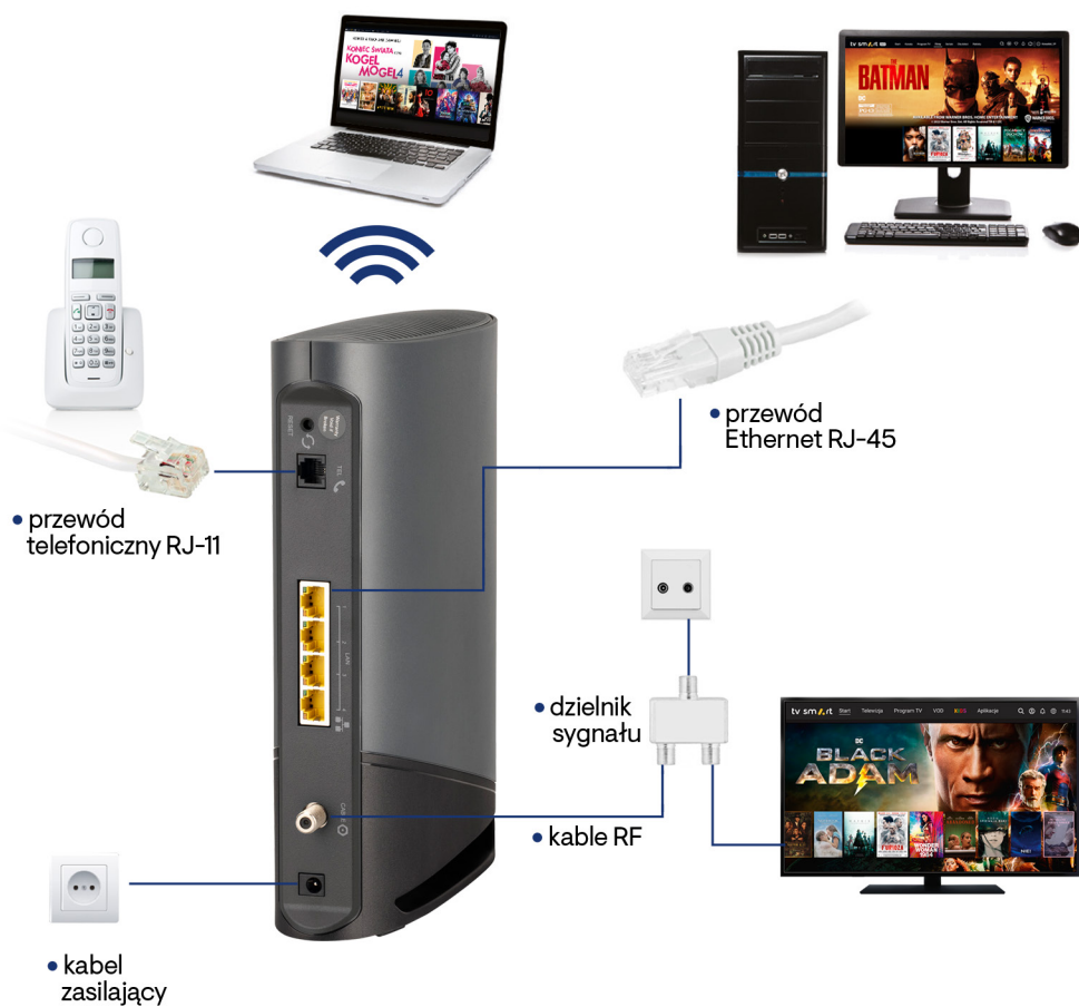
Zdjęcie 3. – Schemat podłączenia modemu.
