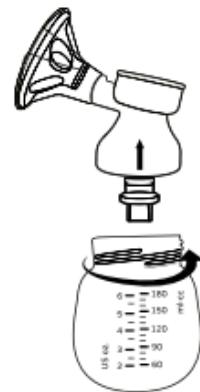
Coloque la válvula en el embudo y enrosque el biberón (como se muestra en la imagen n.º 2).
