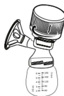
Legen Sie das Panel über die Membrane und drehen Sie es im Uhrzeigersinn (wie in Abbildung Nr. 4 gezeigt).
