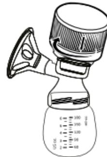
Na membranu staviti panel i okrenuti ga u smjeru kazaljki na satu (kako je prikazano na slici broj 4).
