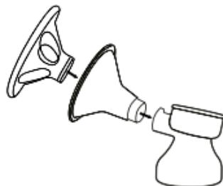
Τοποθετήστε το κάλυμμα σιλικόνης στην ασπίδα στήθους (όπως φαίνεται στην εικόνα 1).
