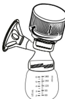
Τοποθετήστε το πάνελ πάνω από τη μεμβράνη και περιστρέψτε δεξιόστροφα (όπως φαίνεται στην εικόνα 4).
