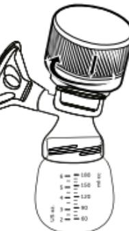
Mettre le panneau sur le diaphragme et visser dans le sens des aiguilles d'une montre (comme sur la fig. 4)
