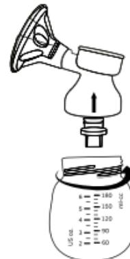
Τοποθετήστε τη βαλβίδα στην ασπίδα στήθους και στη συνέχεια βιδώστε επάνω της το μπουκάλι τροφής (όπως φαίνεται στην εικόνα 2).
