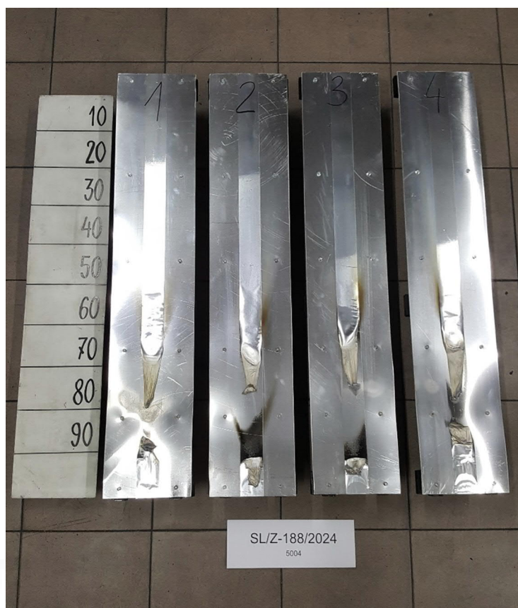
Rys. 5. Wygląd próbek 4 po badaniu - TAŚMA ALUMINIOWA ALU-HOT 5004 50 \mu\text{m} – powleczona klejem akrylowym
