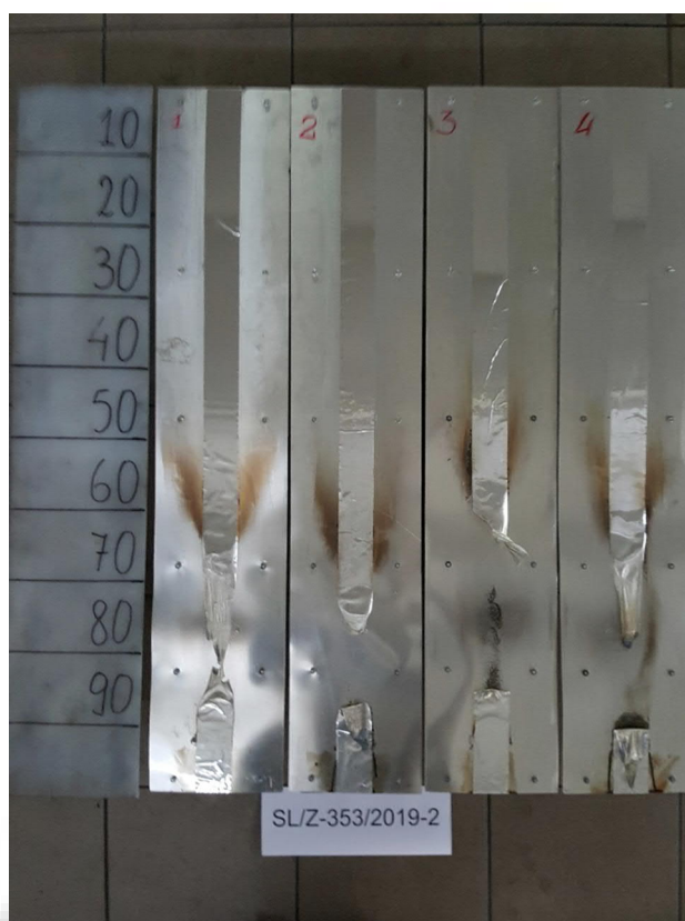
Rys. 3. Wygląd próbek 2 po badaniu – Taśma kominkowa 200 st; ALU-HOT TAPE 5004, 50 mic
