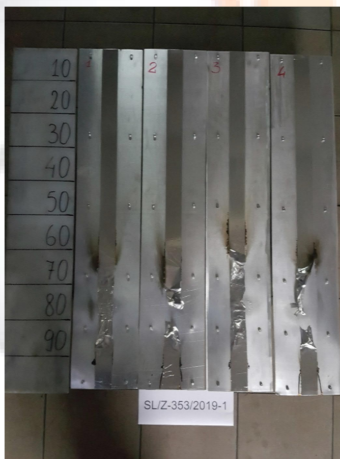
Rys. 2. Wygląd próbek 1 po badaniu – Taśma aluminiowa gładka 660 SR
