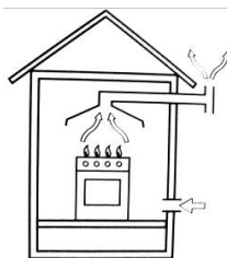
Wylot bezpośredni na zewnątrz.
