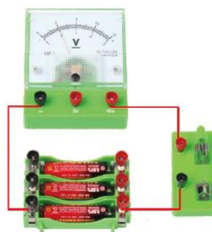
Rys. 12-2: Zestaw 3 baterii połączonych równolegle
