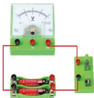
Rys. 12-1: Zestaw 2 baterii połączonych równolegle
