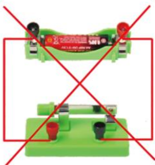
Rys. 1-3: Błędne połączenie, brak odbiornika w obwodzie. Zamknięcie łącznika spowoduje zwarcie i uszkodzenie baterii.
