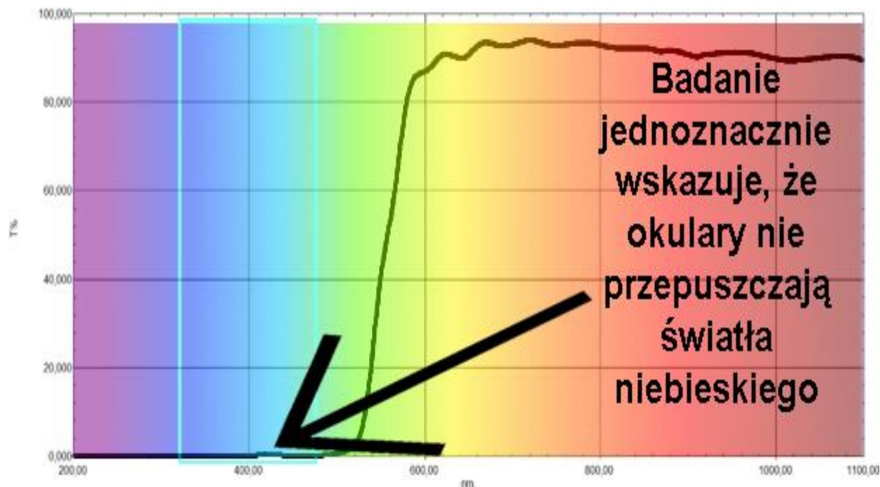
Rys.5. Widmo UV-Vis badanej soczewki z nałożonymi
