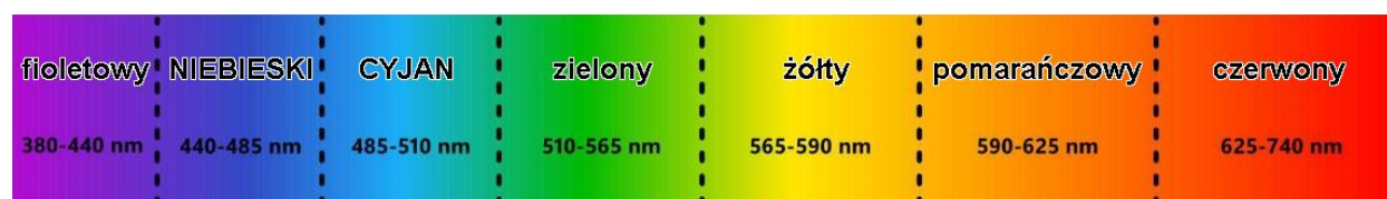
Rys.6. W badaniu przyjęto następujące zakresy widma
