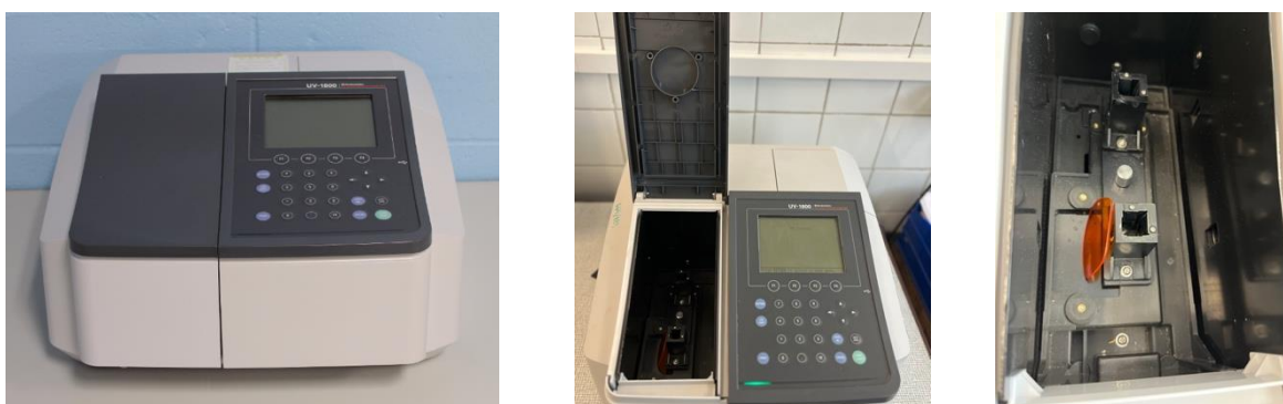
Rys.3. Zastosowany spektrofotometr UV-Vis wraz z próbką
