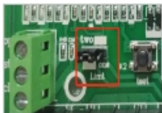
Rys.3 Widok zworki zmiany trybu pracy krańcówek
