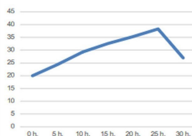
Wzrost temperatury wiązania żywicy pox Max 400 Crystalline UV skl. A z utwardzaczem pox Max 400 Crystalline UV skl. B (warstwa 100mm. w temperaturze 20°C) °C.
