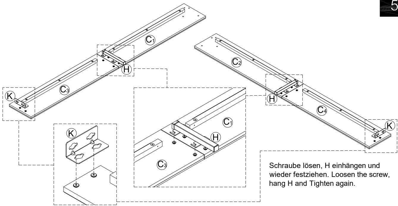
Schraube lösen, H einhängen und wieder festziehen. Loosen the screw, hang H and Tighten again.
