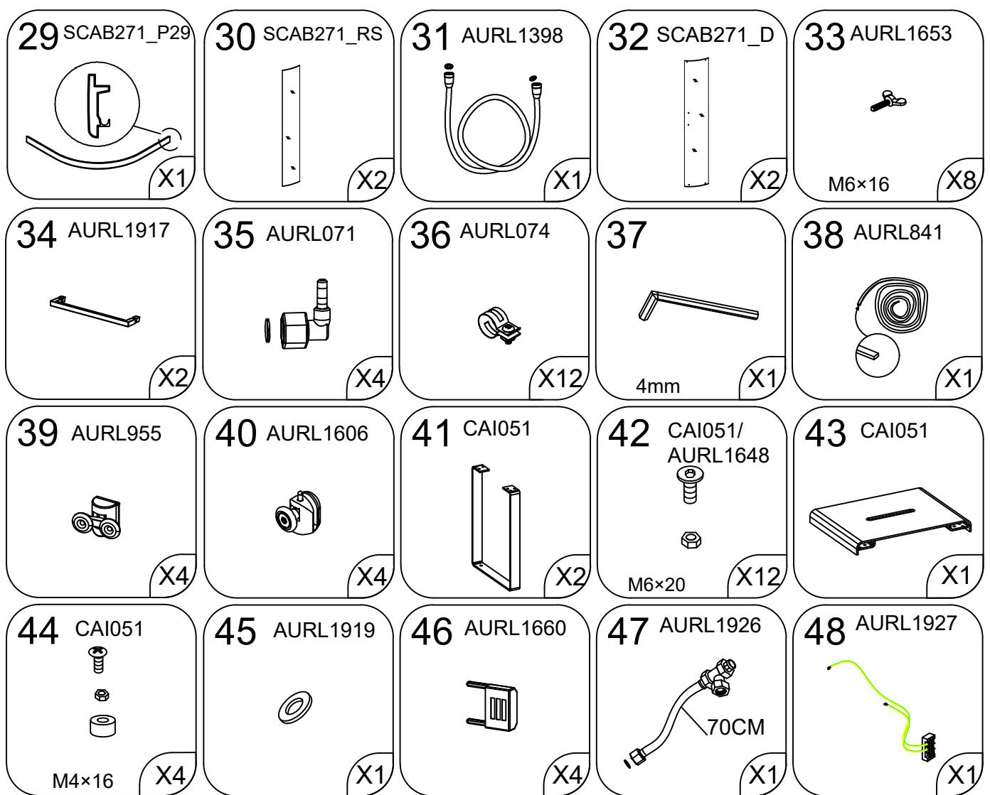
N°47 / N°48 : Pieces préinstallées / Pre-installed parts / Piezas preinstaladas / Pecas pre-instaladas / Parti préinstallé / Voorgeïnstalleerde onderdelen / Vorinstallierte Teile
