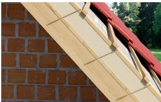
Montaż izolacji nakrokwiowej twardej Materiał izolacyjny o wysokiej wytrzymałości na ściskanie ( \sigma(10\%) \geq 50 \text{ kPa} - EN 826)
