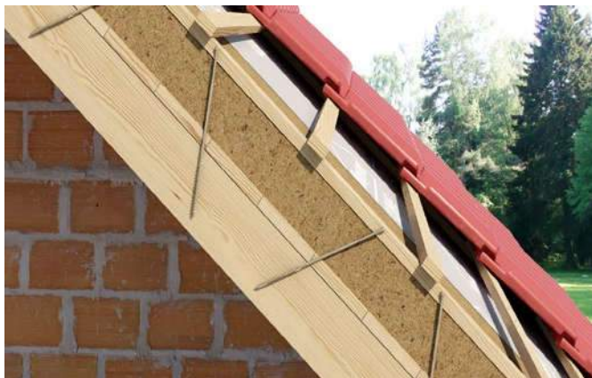
Montaż izolacji nakrokwiowej miękkiej Materiał izolacyjny o niskiej wytrzymałości na ściskanie ( \sigma(10\%) < 50 \text{ kPa} - EN 826)
