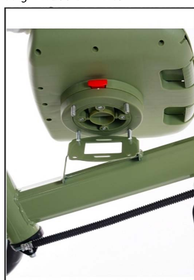
Przymocuj siedzisko do ramy Attach the seat to the frame
