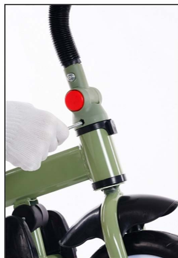
Widły przymocowane do ramy Forks secured to the frame
