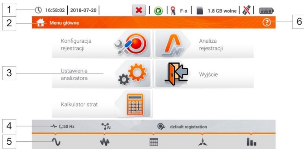
Rys. 5.2 Główne elementy ekranu rejestratora
