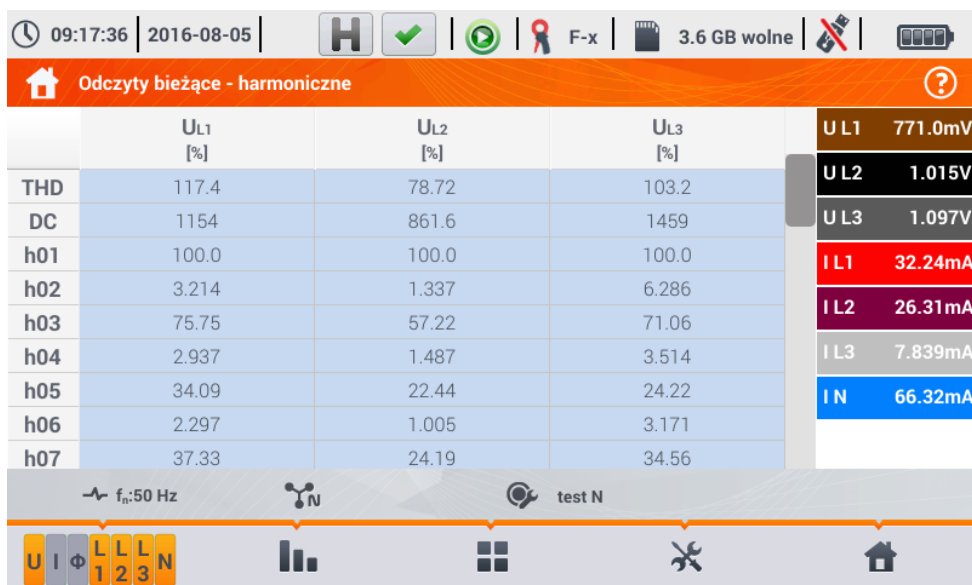
Rys. 5.18. Odczyty bieżące - harmoniczne - widok tabelaryczny
