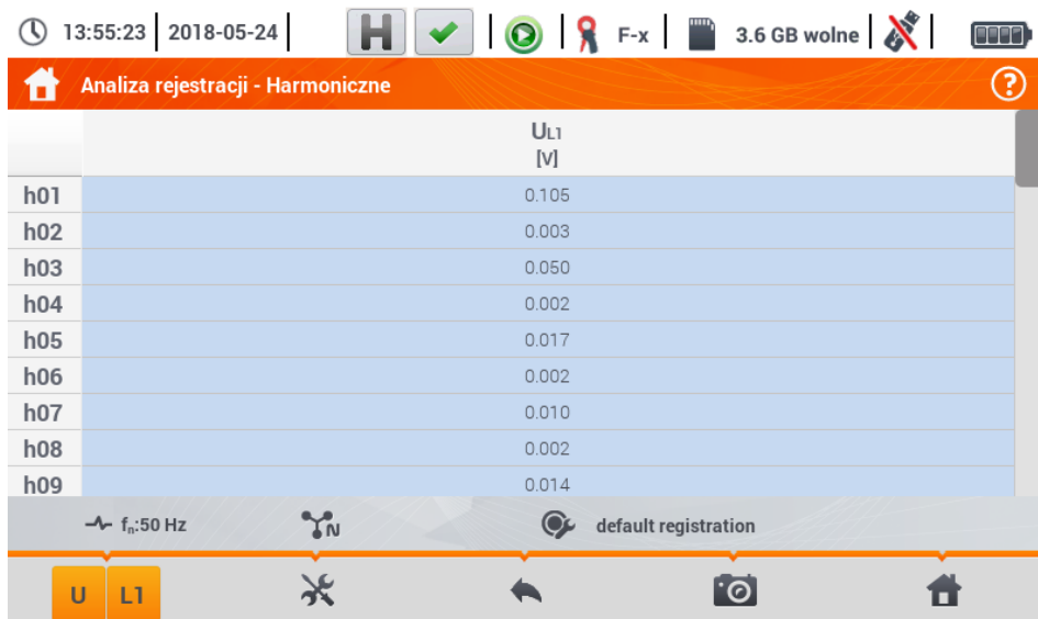
Rys. 5.24. Odczyty bieżące - harmoniczne - widok tabelaryczny
