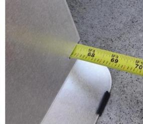
Pomiar taśmy tylnej (strona skierowana do tyłu pojazdu) minus pomiar taśmy przedniej (strona najbliższa przodu pojazdu) to całkowity zbieżność osi. Większy pomiar z przodu oznacza zbieżność na zewnątrz, a większy pomiar z tyłu oznacza zbieżność do wewnętrz.
