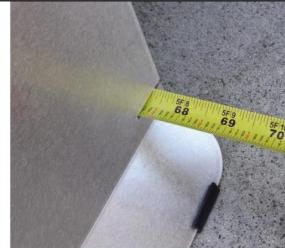
La medida de la cinta trasera (lado que mira hacia la parte trasera del vehículo) menos la medida de la cinta delantera (lado más cercano a la parte delantera del vehículo) es la convergencia total del eje. Una medida más grande en el lado delantero indica convergencia hacia afuera, y una medida más grande en el lado trasero indica convergencia hacia adentro.
