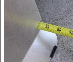
Der hintere Maßbandwert (Seite zum Fahrzeugheck) minus dem vorderen Maßbandwert (Seite zur Fahrzeugfront) ergibt die Gesamtspur der Achse. Ein größerer Wert auf der Vorderseite gibt die Nachspur an, ein größerer Wert auf der Rückseite die Vorspur.
