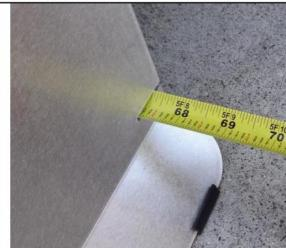
Det bakre bandmåttet (sidan mot fordonets bakre del) minus det främre bandmåttet (sidan närmast fordonets framsida) är den totala tåna på axeln. Ett större mått på framsidan indikerar tå ut och ett större mått på baksidan indikerar tå in.
