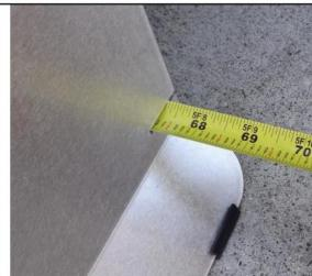
La mesure du ruban arrière (côté vers l'arrière du véhicule) moins la mesure du ruban avant (côté le plus proche de l'avant du véhicule) correspond au pincement total de l'essieu. Une mesure plus grande sur le côté avant indique le pincement vers l'extérieur, et une mesure plus grande sur le côté arrière indique le pincement vers l'intérieur.
