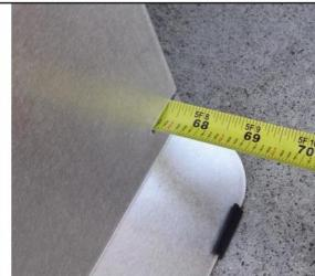
De achterste tape-meting (zijde richting de achterkant van het voertuig) min de voorste tape-meting (zijde het dichtst bij de voorkant van het voertuig) is de totale toespoor van de as. Een grotere meting aan de voorkant geeft toespoor aan, en een grotere meting aan de achterkant geeft toespoor aan.
