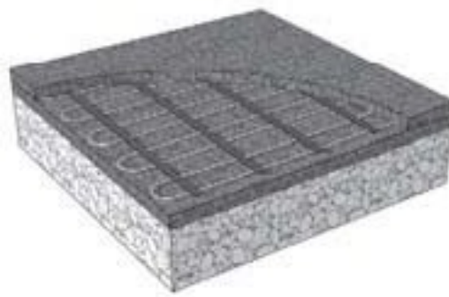
Kabel MA ICE-30 v asfaltu
