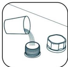
②. ÖFFNEN SIE DEN WASSERVERSORGUNGSEINLASS, UM KÜHLWASSER ZUZUFÜHREN (DAS WASSER NICHT AUSSCHÜTTEN!).
