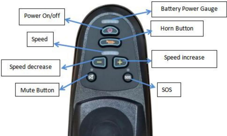
Panel del controlador
