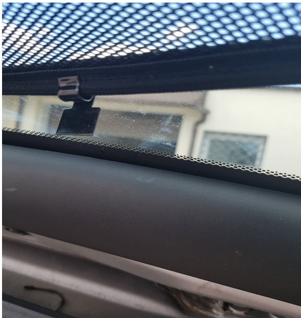
Rys.10 - sposób zamocowania zaczepu w klapie bagażnika
