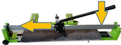
Tip: Als deze lijn niet doorlopend is, kan de tegel niet worden gesneden.
