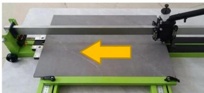
Astuce : Poussez l'extrémité avant de la tuile vers l'avant avec une force uniforme.
