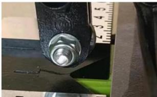
Das erste Werkzeugrad steckt in der Werkzeugablage des Maschinenkopfs fest. Verwenden Sie M6\*25 Schrauben, um Von außen das Loch bohren und die Mutter festziehen.
