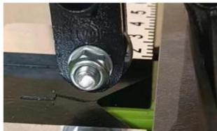
La primera rueda de herramientas está atascada en el soporte de la herramienta del cabezal de la máquina. Utilice tornillos M6\*25 para
