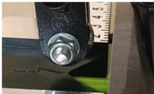
La première roue d'outil est coincée dans le support d'outil de la tête de la machine. Utilisez des vis M6\*25 pour Percez le trou de l'extérieur et serrez l'écrou.
