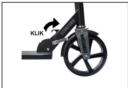
3. Rozłóż hulajnogę do momentu usłyszenia wyraźnego dźwięku zatrzaśnięcia mechanizmu.
