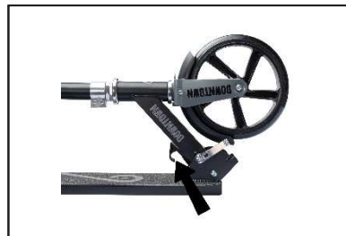
2. Heben Sie den Hebel des Mechanismus nach oben
