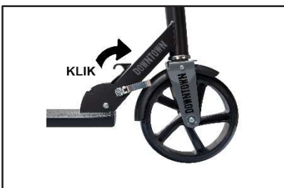
3. Klappen Sie den Roller aus, bis Sie ein deutliches Einrastgeräusch des Mechanismus hören
