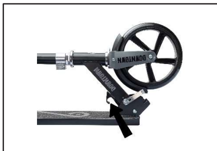
2. Unieś dźwignię mechanizmu do góry.
