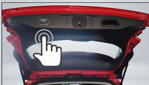
Dedykowane przyciski do sterowania otwieraniem/zamykaniem bagażnika
