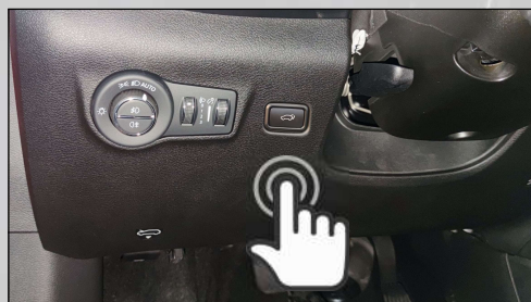
Dedykowane przyciski do sterowania otwieraniem/zamykaniem bagażnika
