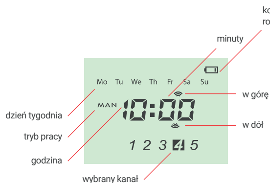
Wyświetlacz nadajnika 5-kanalowego z programatorem czasowym.
