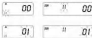
5. Continuez le réglage du numéro de réglage **O1** à 11 en appuyant sur **[+]** (E) ou faites glisser le commutateur de configuration vers la droite pour terminer et quitter le réglage.
