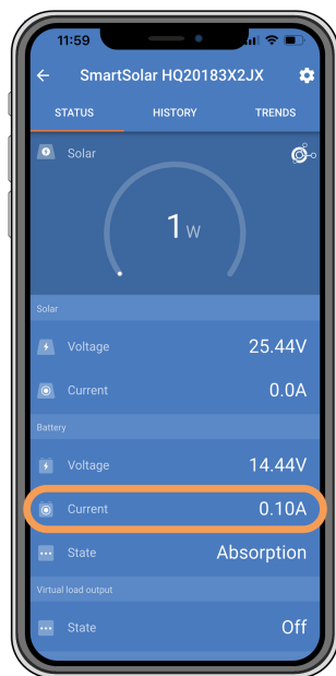
Aplikacja VictronConnect pokazuje prąd ładowania bliski zeru.
