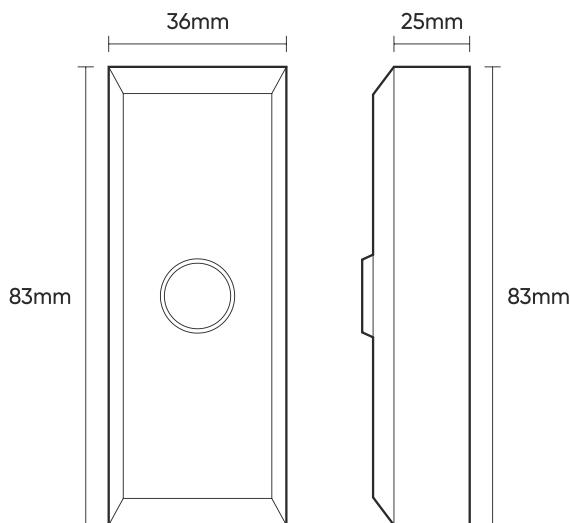
**PL** Bardzo małych rozmiarów przycisk, przeznaczony do pracy w systemach kontroli dostępu. Pozwala na otwarcie drzwi wyposażonych w elektrozaczep.
