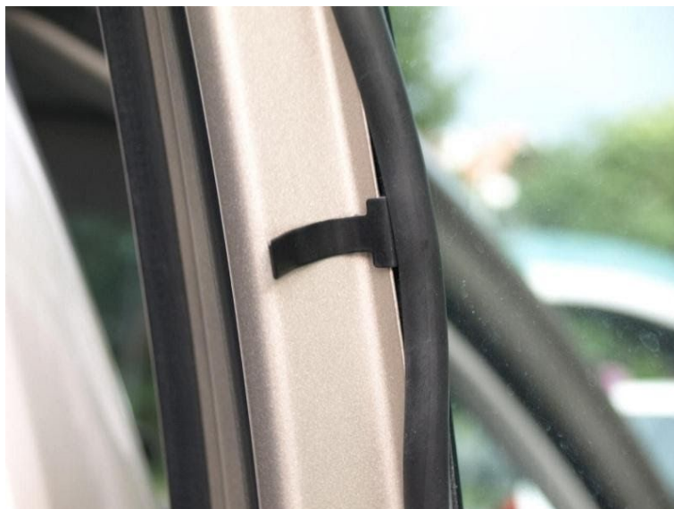
Zdjęcie nr 2 - Sposób montażu blaszek
