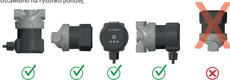
Rys. 2. Dopuszczalne pozycje montażowe pompy APW
