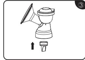
Das Silikonventil installieren und sicherstellen, dass der Teil luftdicht am Öffnungsrand anliegt.
