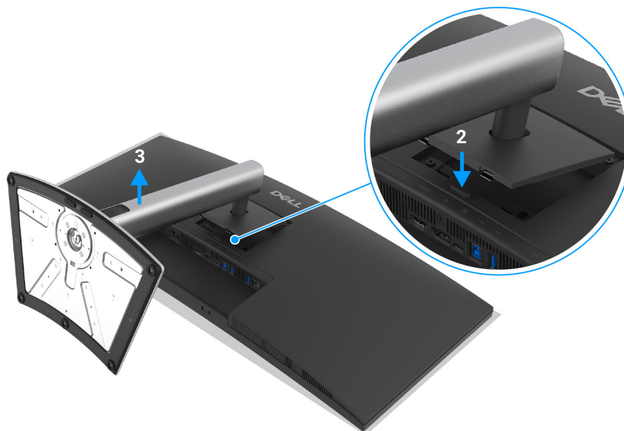
Rysunek 48. Zdejmowanie podstawy monitora
