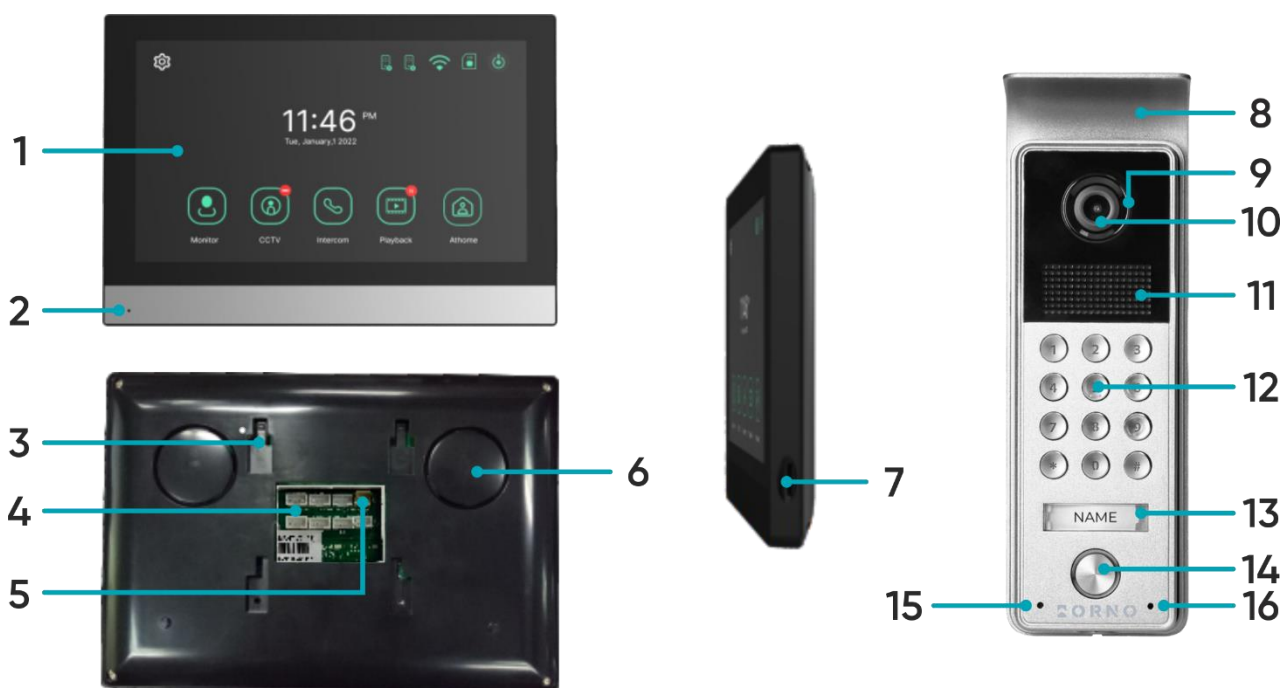
rys. 1 Budowa video monitora i panelu zewnętrznego
