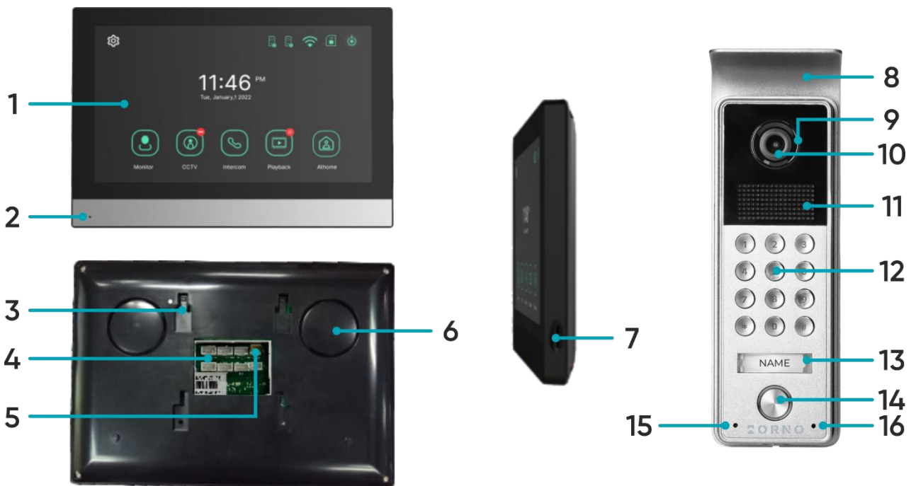
Abb. 1 Aufbau des Monitors und der Außenstation mit Kamera
